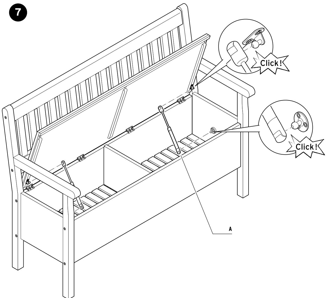
**Klappenhalter lösen | Détacher les ressorts pneumatiques | Distaccare la cerniera del coperchio**
